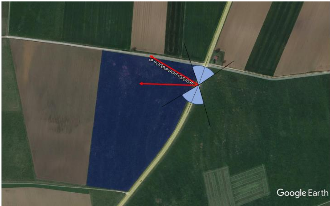
Abbildung 11: Vergleich Sichtfeld Fahrzeugführer für Punkt A4 mit Grenzvektoren in Richtung Module
