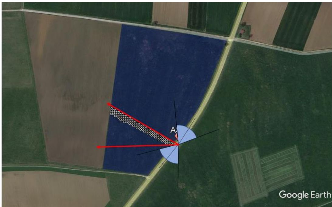
Abbildung 10: Vergleich Sichtfeld Fahrzeugführer für Punkt A3 mit Grenzvektoren in Richtung Module
