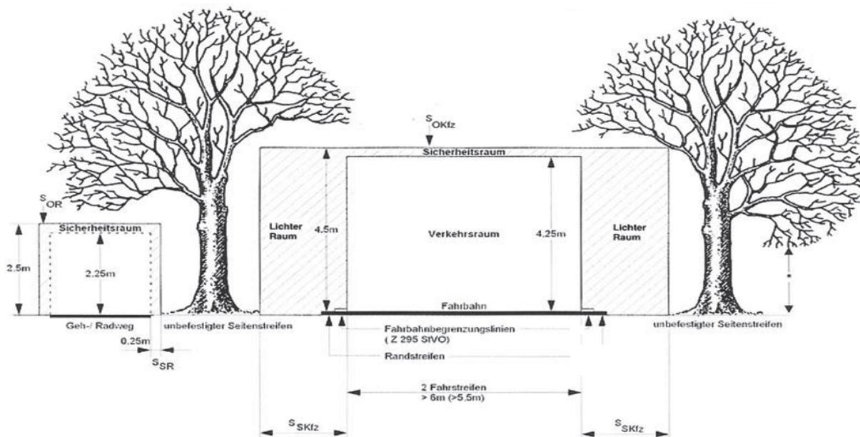
S<sub>s</sub> = seitlicher Sicherheitsraum    S<sub>o</sub> = oberer Sicherheitsraum    R = Radfahrer    Kfz = Kraftfahrzeug
