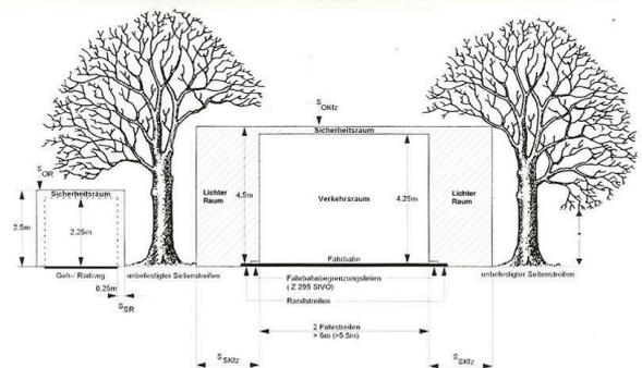
S<sub>2</sub> = seitlicher Sicherheitsraum S<sub>0</sub> = oberer Sicherheitsraum R = Radfahrer Kfz = Kraftfahrzeug
